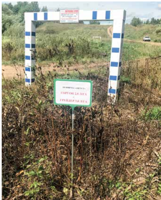
Фото 21. Эффективность баковой смеси Горгон® + Грейдер® (через 40 дней после обработки) при доочистке охранной зоны подземного нефтепровода после применения мульчерной технологии искоренения ДКР. АО «Транснефть – Верхняя Волга» – Володарское РНПУ, Московская область, Домодедовский р-н, 2018 г.
